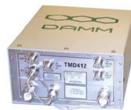
Выносной антенный усилитель с дуплексным фильтром
